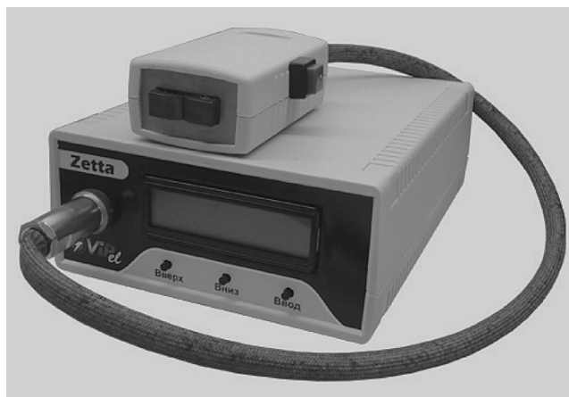
Устройство для снятия изоляции с проводов.
