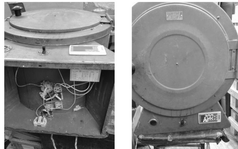
Рис. 3 - Фотографии модернизированной лабораторной печи для сушки обмоток трансформаторов малой мощности
